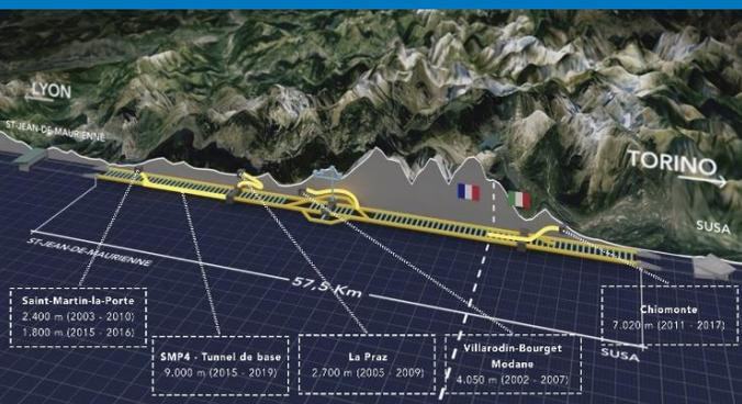
Les chantiers pour la réalisation du tunnel de base du Lyon-Turin, principal ouvrage de la section transfrontalière sont en cours. Le tunnel de base est une infrastructure complexe composée de 2 tubes parallèles de 57,5 km, environ 170 rameaux de communication et 4 accès intermédiaires.
